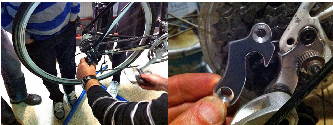
Réglage des butées haute et basse
